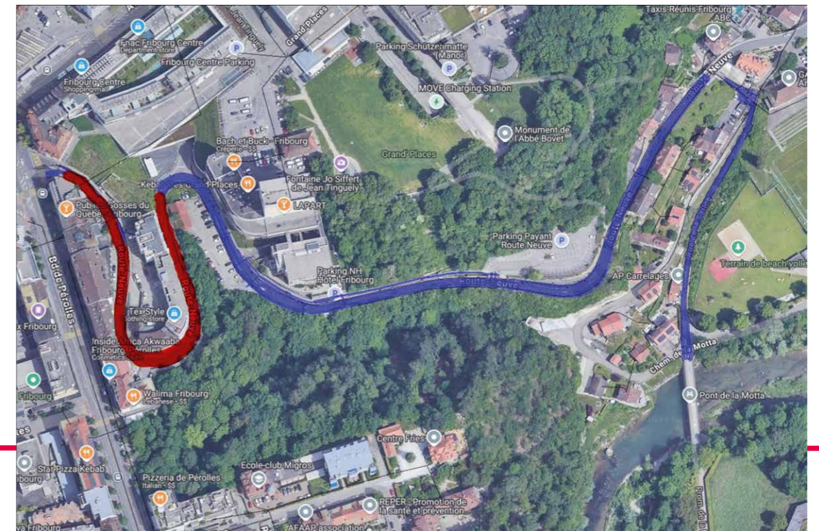
Vue détaillée de la zone de détection avec couverture GPR-Scan en bleu (Route-Neuve et Rue de la Saline). Zone de détection avec scan en mode grille en rouge (Route-Neuve)
